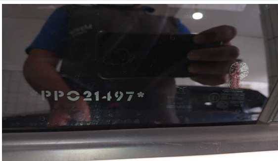
Gravação de Chassi nos Vidros:
